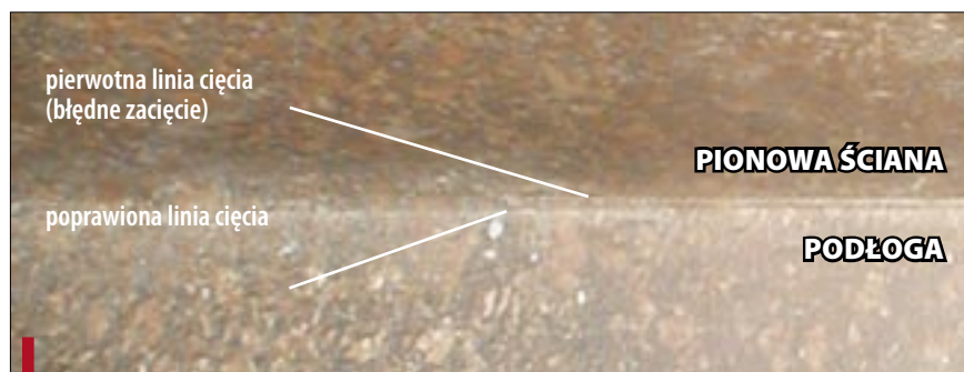
Fot. 2. Poprawiane cięcie na styku pionowej ściany z podłogą sarkofagu. Materiał: granit, szerokość śladu narzędzia 5-7 mm
