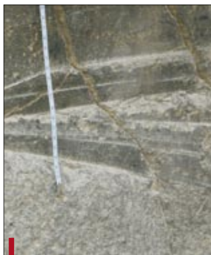
Fot. 4. Widoczne wyraźne ślady cięcia na bloku bazaltowym, kilkakrotnie poprawianego.
